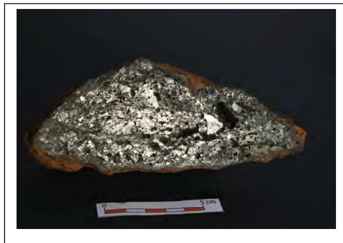
Photo n° 96 : bloc riche en métal DM1 ; fer métal massif, vu en coupe.
