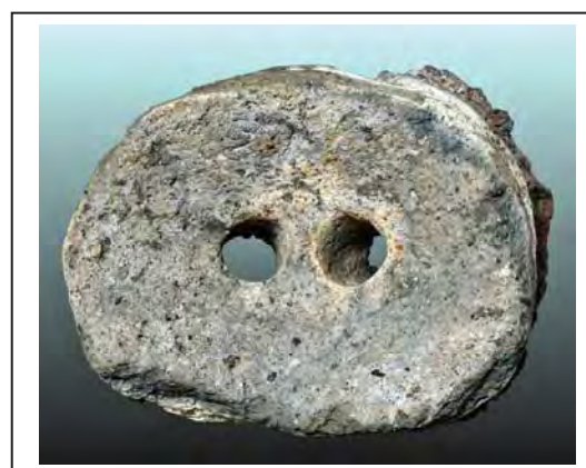
Photo n° 117 : bloc-tuyère bifide TBF 1.
