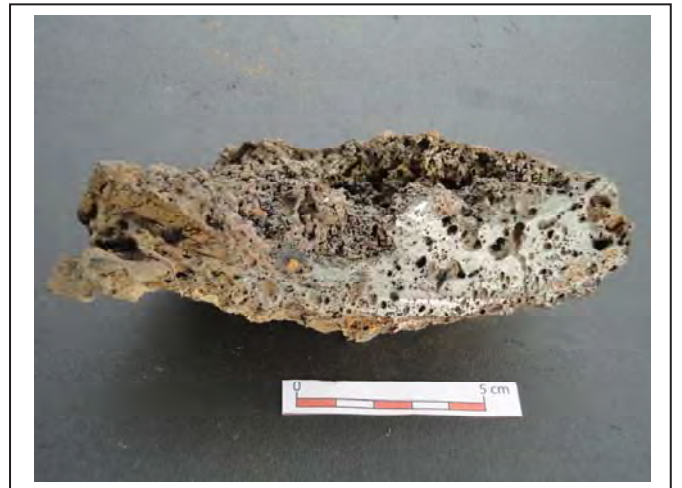
Photo n° 86 : scorie Sc138 ; fer métal en réseau, vu en coupe.
