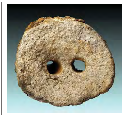
Photo n° 112 : bloc-tuyère bifide TBF 12.
