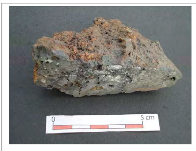
Photo n° 97 : bloc riche en métal DM2 ; trouvé en prospection électromagnétique (m= 190 g).
