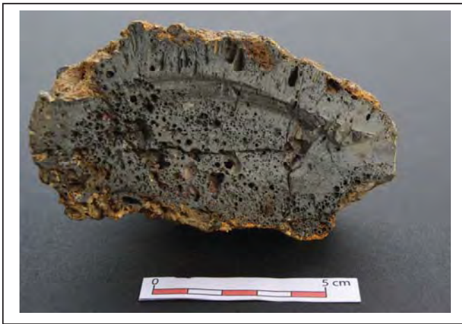
Photo n° 89 : scorie à pellicule d'oxydes ; vue en coupe de la matrice fayalitique ; moitié nord du bâtiment.
