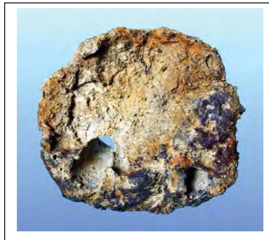
Photo n° 119 : bloc-tuyère bifide TBF 16.
