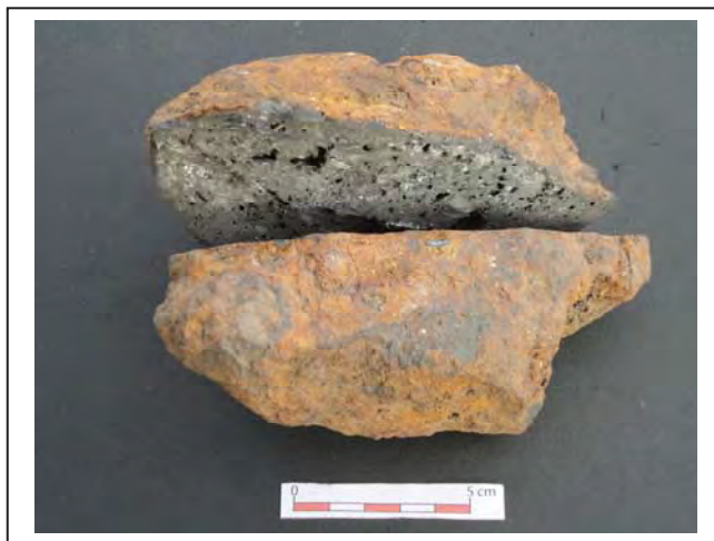
Photo n° 95 : bloc riche en métal DM1 ; trouvé en prospection électromagnétique (m = 1,325 kg).
