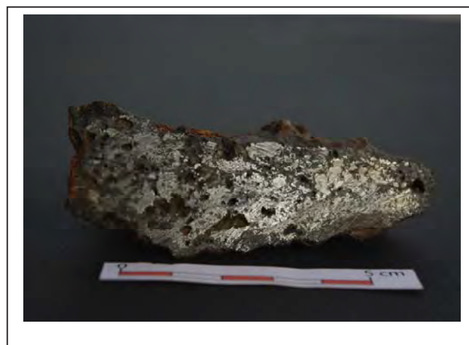
Photo n° 98 : bloc DM2 ; fer métal massif, vu en coupe.
