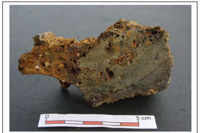
Photo n° 94 : scorie à oxydes de fer contenant du fer métal en bordure des phases fayalitiques.
