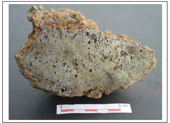
Photo n° 84 : scorie Sc137; phases de fer métal dispersées dans la matrice, vues en coupe.
