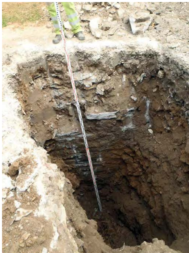
Fig. 90 : Le parement ouest du moineau, mis au cours d'un sondage géotechnique. Cl. Fondasol (rapport ANB.15-0069-pièce n°001. 1ère diffusion), agence de Brest, 2015, p. 17.
