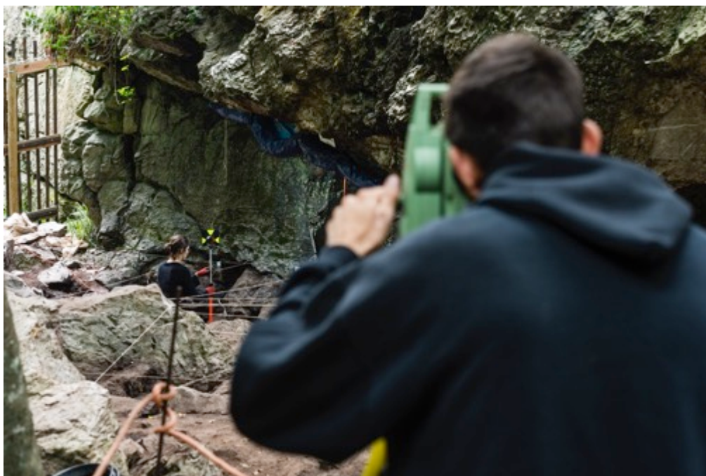
Figure 17. Relevé d'une pièce au tachéomètre laser (C. Frésillon, CNRS).
