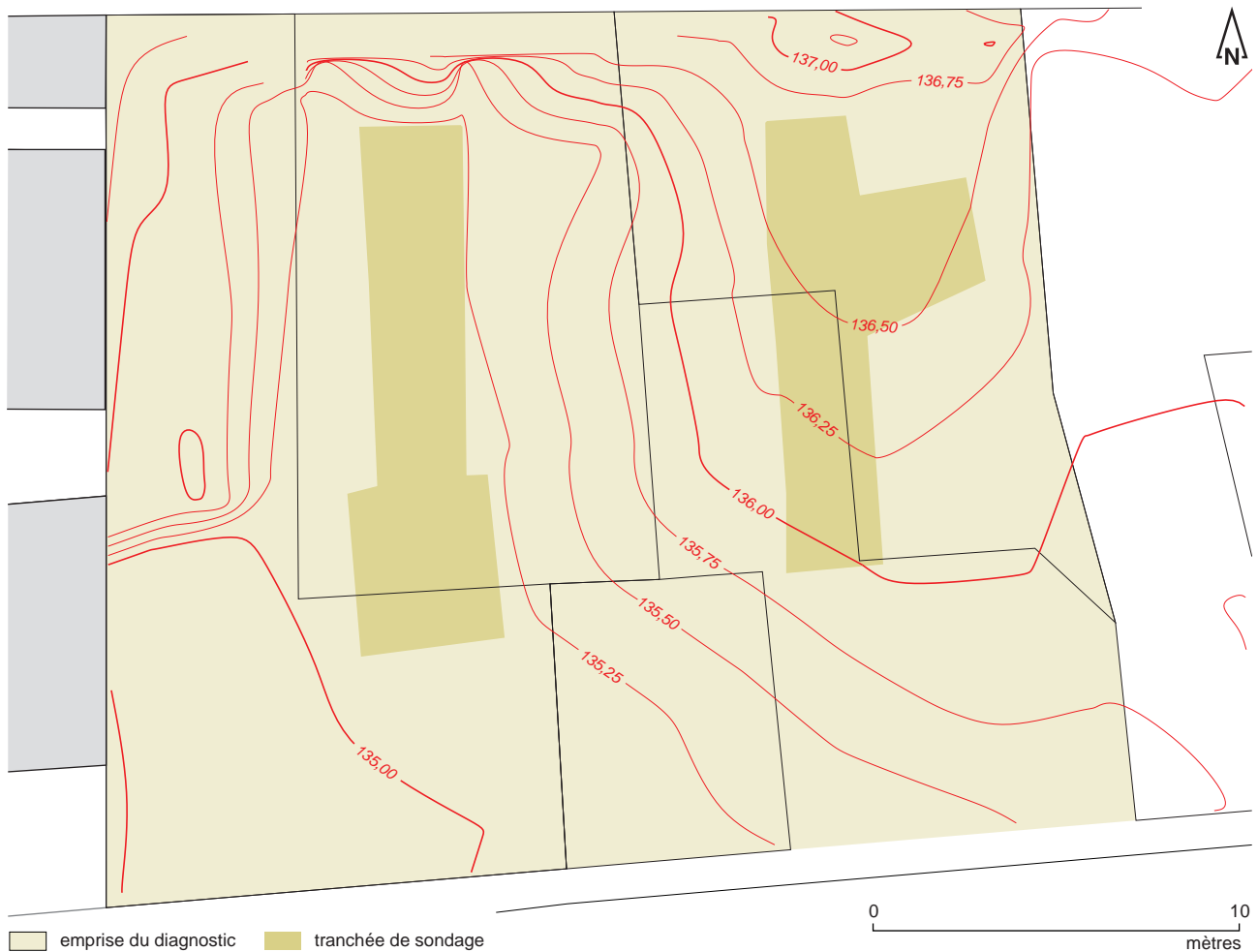
Fig. 5 Le relevé topographique de l'emprise diagnostiquée fait clairement apparaître la différence de niveau qui existe entre sa partie ouest et sa partie est.
