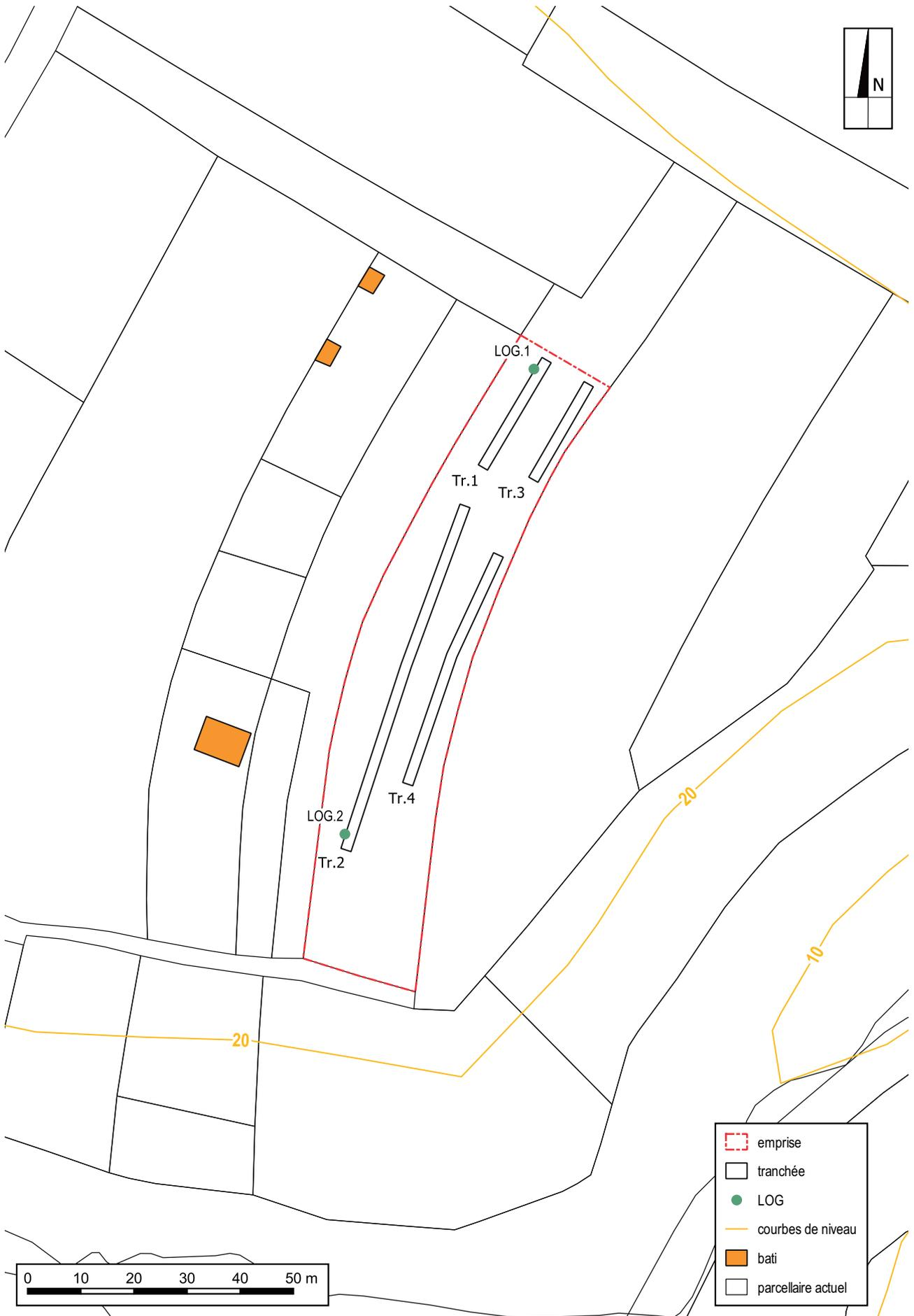
Fig. 1 Plan masse de l'opération avec courbes de niveaux et localisation des LOG. © David Gâche, Inrap
