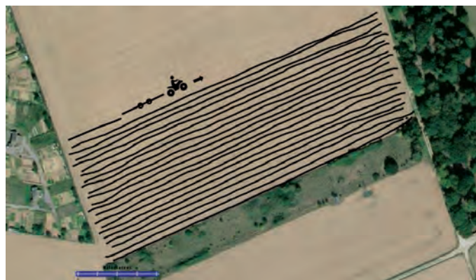
Figure ARP2 : Parcours d'acquisition et points de mesures (maille large). L'écartement inter profil peut varier.
