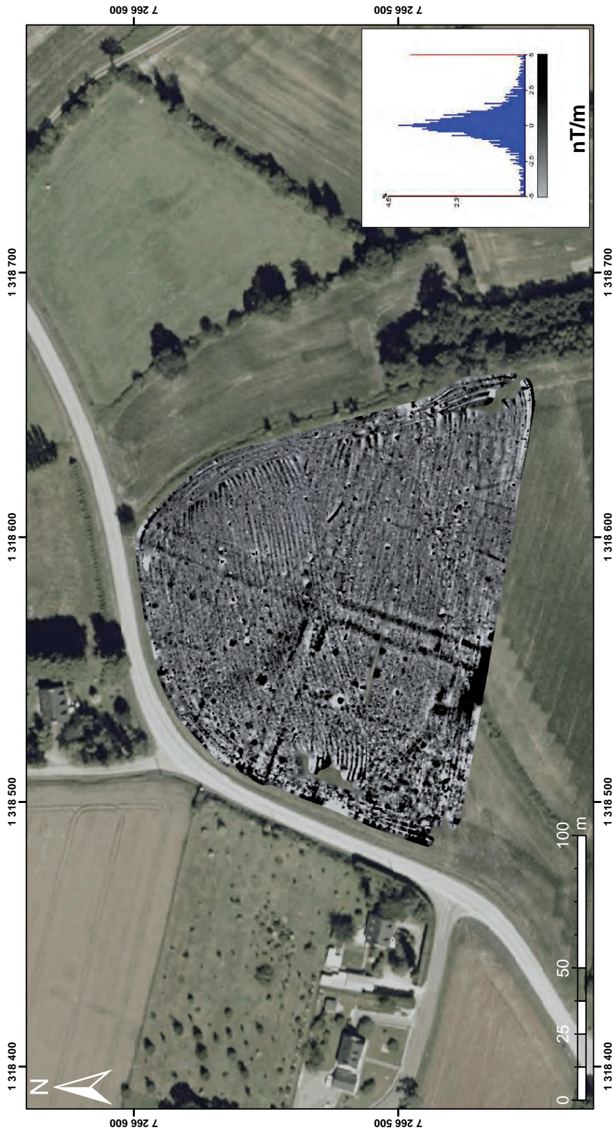
Annexe 13 : Carte de gradient magnétique - P4 - Echelle : -5/5 nT/m
