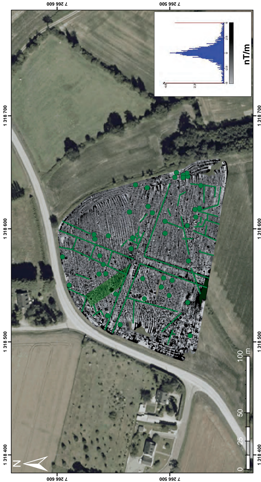
Annexe 18 : Carte de vectorisation et de gradient magnétique - P4 - Echelle : -5/5 nT/m
