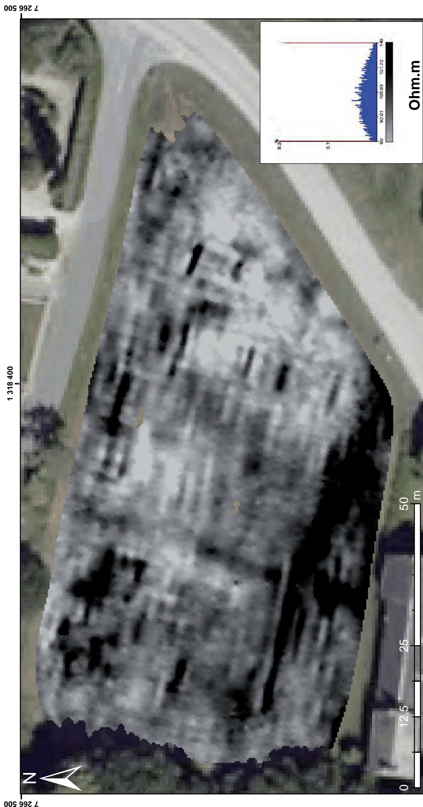
Annexe 9 : Carte de résistivité apparente - P5 - Profondeur d'investigation : 0 - 170 cm - Echelle : 80-140 ohm.m
