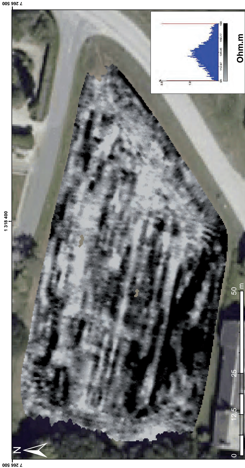
Annexe 7 : Carte de résistivité apparente - P5 - Profondeur d'investigation : 0 - 50 cm - Echelle : 95-190 ohm.m
