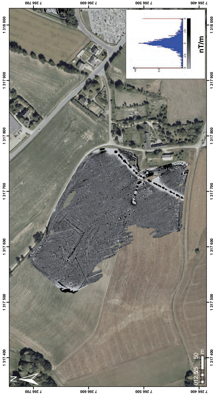
Annexe 10 : Carte de gradient magnétique - P1 - Echelle : -5/5 nT/m
