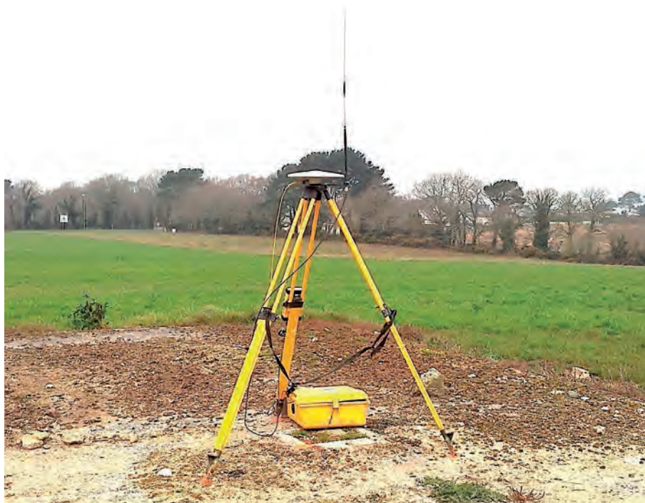
Figure A2 : Base GNSS RTK de la marque Trimble. Valise, trépied, mobile, antenne satellite et antenne radio.
