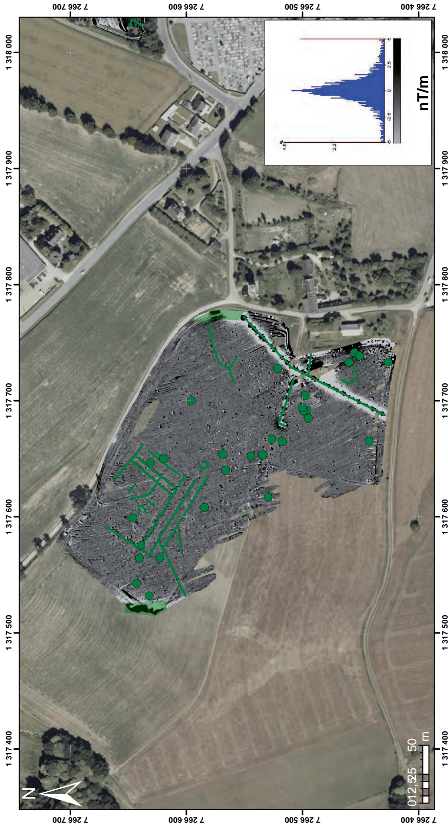
Annexe 15 : Carte de vectorisation et de gradient magnétique - P1 - Echelle : -5/5 nT/m
