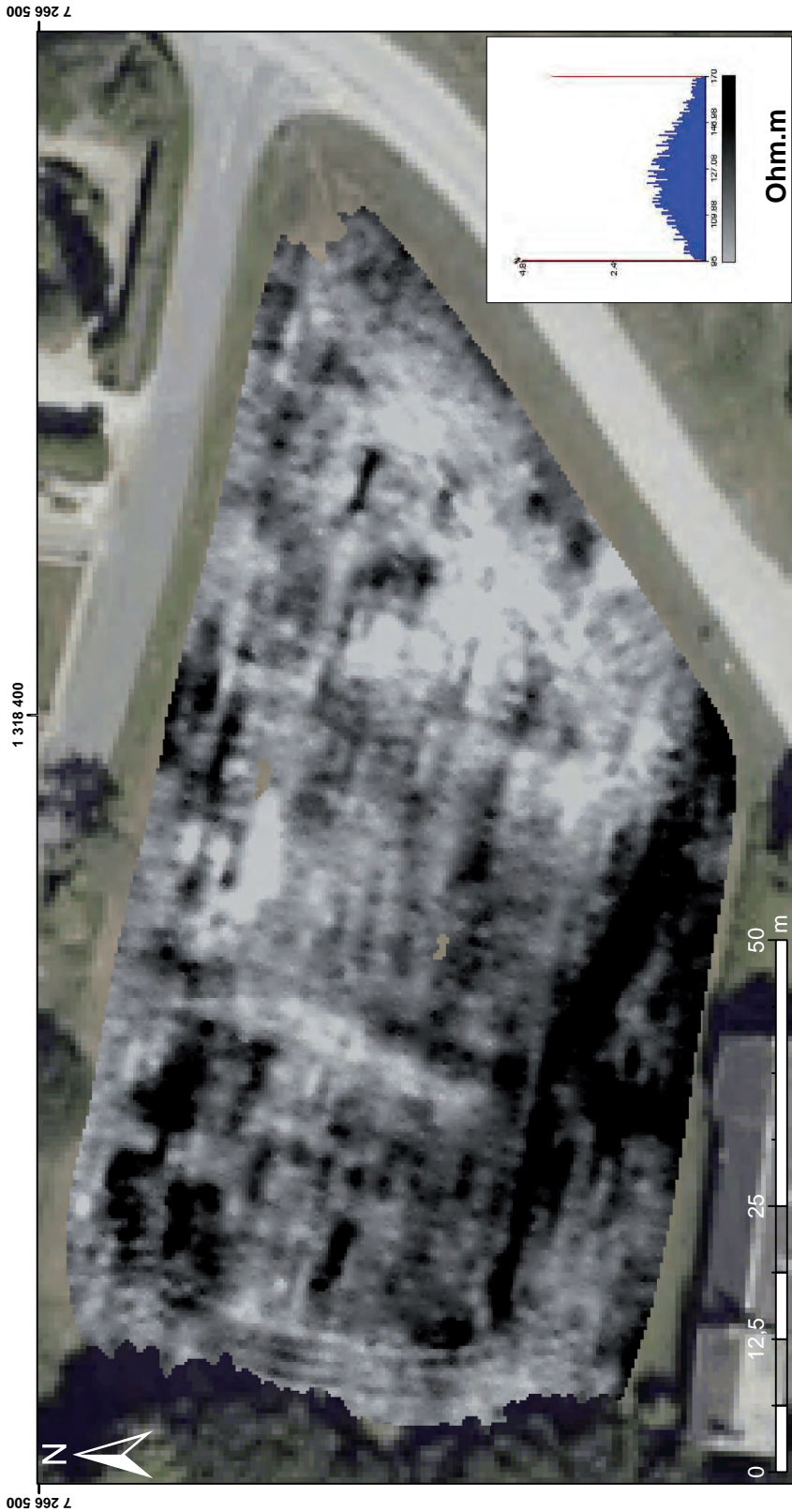
Annexe 8 : Carte de résistivité apparente - P5 - Profondeur d'investigation : 0 - 100 cm - Echelle : 95-170 ohm.m
