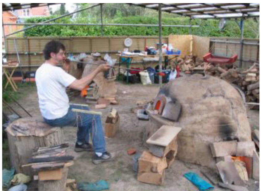
Fig.216 : Four de verrier antique expérimental en cours d'essai. Le souffleur de verre travaille assis devant son four comme sur l'illustration fig.214. © ( http://www.glasrepliken.de/p_glasofenexperiment_VFP.htm )
