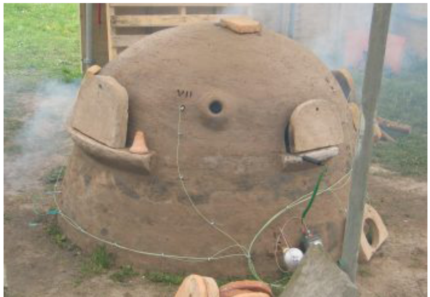
Fig.215 : Four de verrier antique expérimental en cours d'essai. Des sondes ont été installées pour mesurer les températures atteintes dans les différents points du four. © ( http://www.glasrepliken.de/p_glasofenexperiment_VFP.htm )
