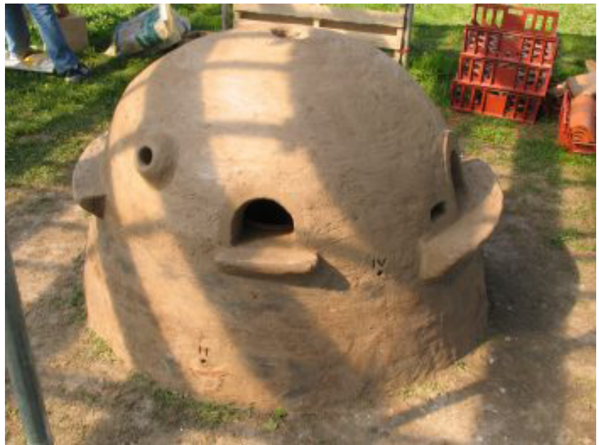
Fig.214 : Four de verrier antique expérimental. © ( http://www.glasrepliken.de/p_glasofenexperiment_VFP.htm )
