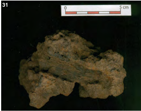
Fig.31 : Scorie piégée à l'intérieur du bas fourneau avec empreintes de gros charbons de bois. © J-B Vivet
