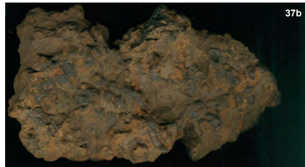
Fig.37 a et b : scorie interne coulée à plat au fond du bas fourneau, vue du dessus (a) et du dessous (b). © J-B Vivet
