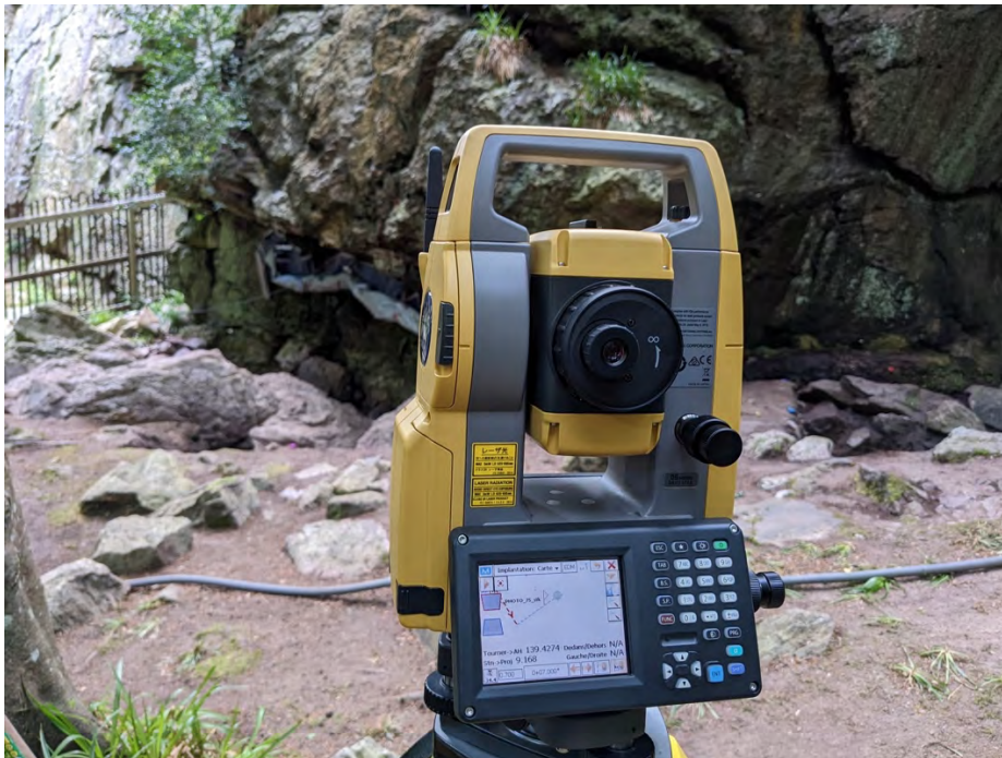
Figure 10. Nouvelle station totale TOPCON lors de l'implantation du carroyage de 2022
