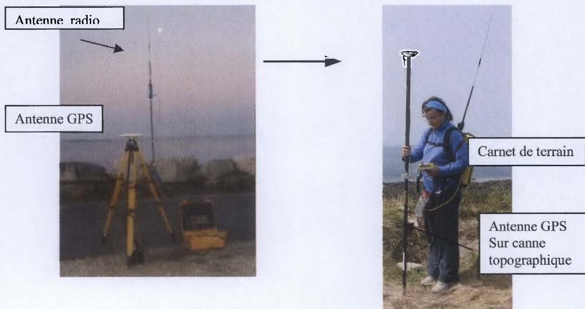
Fig. 9 : Principe du RGP (Réseau GPS Permanent) utilisé dans ce cadre.
