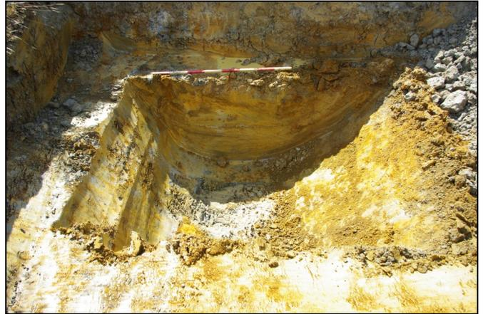
Photo 54 : creusement au godet large : argile délavée du fond du puits et encaissant schisteux-argileux ocre.
