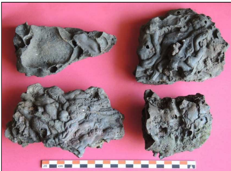
Scories de type écoulé à successions de cordons denses étroits, à cordons larges et aplati et à succession de cordons fondus entre eux (face supérieure)
