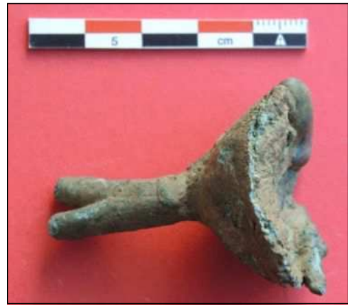
Fig. 41 : Cône de coulée en bronze
