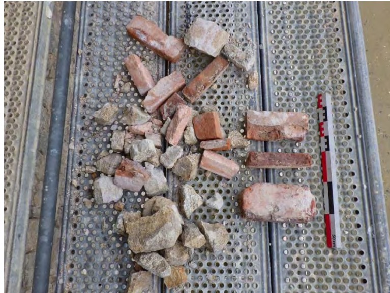
Figure 36: éléments de briques et de pierres du bouchage masquant le blason
