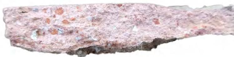
**Figure 24:** Section d'un fragment d'enduit du four, épaisseur max. 3 cm (R. Louessard)
