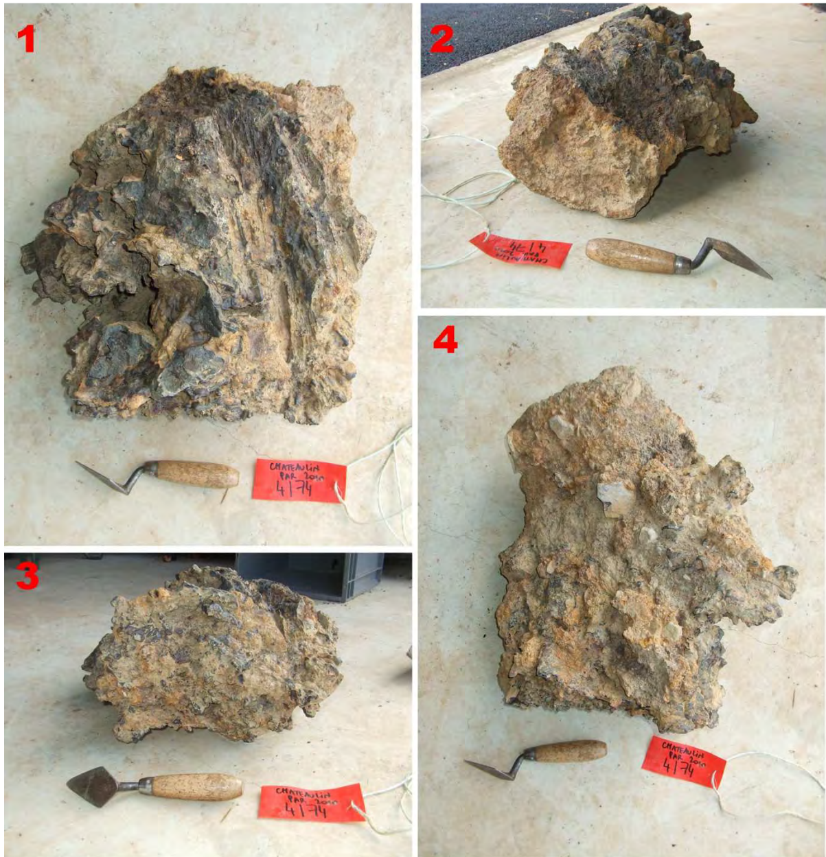
Fig. 3 : Fragment de culot de scorie piégée F. 4174, trouvé dans un fossé 1 : Face interne ; 2 : Face supérieure ; 3 : Face inférieure ; 4 : Face externe
