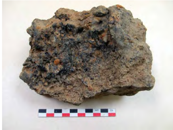
Fig. 6 : Fragment de paroi présentant une surface interne vitrifiée et déformée
