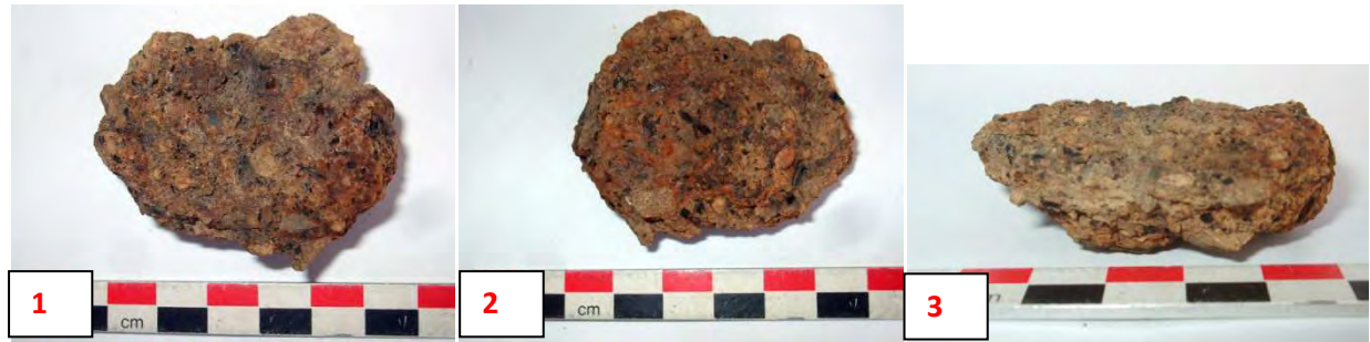
Fig. 22 : petite scorie de forge en calotte provenant de la structure F. 1612 (1) : Face supérieure ; (2) : face inférieure ; (3) : face latérale
