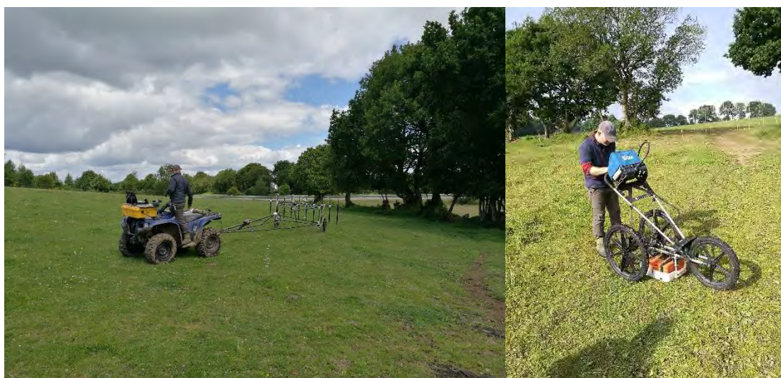
Figure 12 : Instrumentation pour la prospection magnétique, à gauche, et géoradar, à droite.
