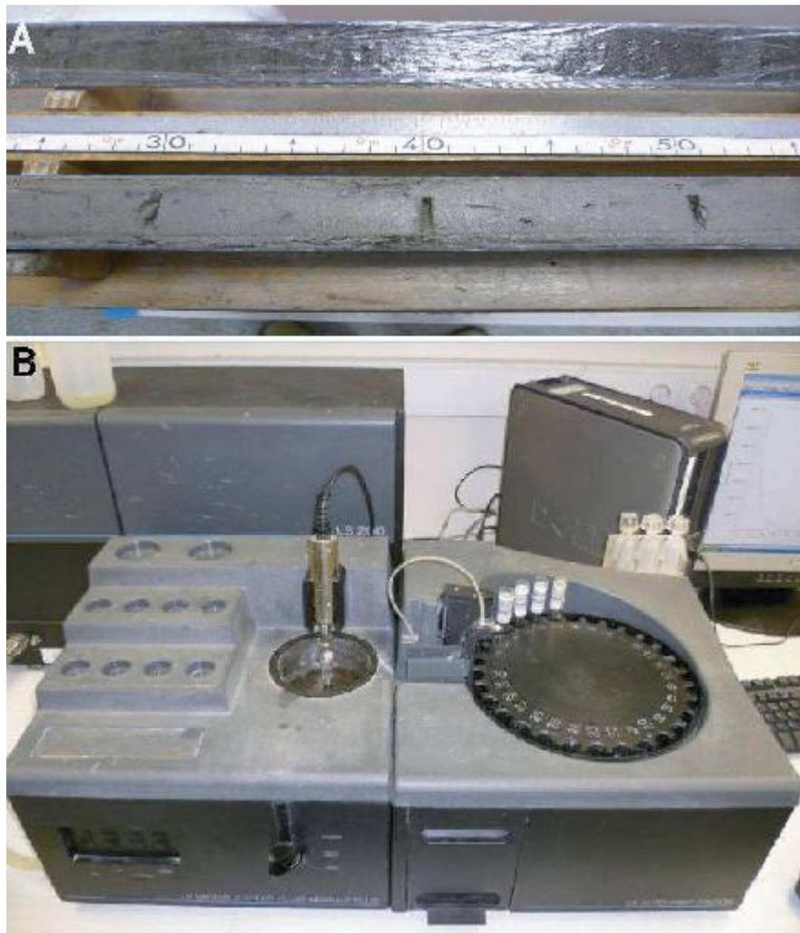
**Fig. 116** - Analyses granulométrique. A. Echantillonnage tous les 10 cm le long des sections. B. Granulomètre laser de type Coulter LS200 utilisé.
