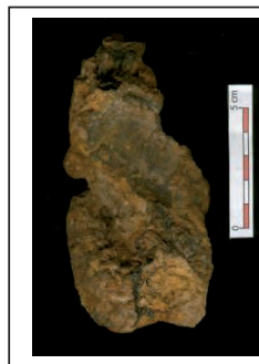
Photos 7 et 8: scories de réduction piégées, (n°2, à gauche et n°4 à droite) avec empreintes de charbons de bois.
