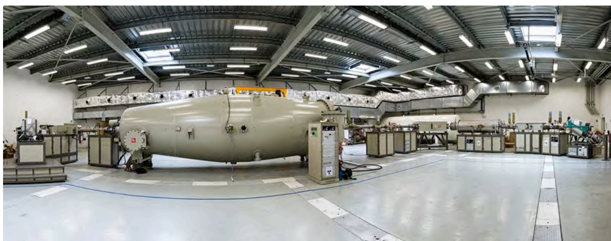
Figure 49. Vue panoramique de l'instrument national spectromètre de masse par accélérateur ASTER (Accélérateur pour les Sciences de la Terre, Environnement, Risques).
