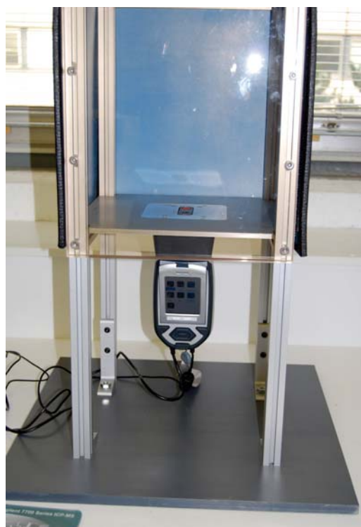
Fig. 70 – Vue du NITON XL3t GOLDD+ et de son enceinte de mesure en laboratoire. Cliché : J.-C. Le Bannier
