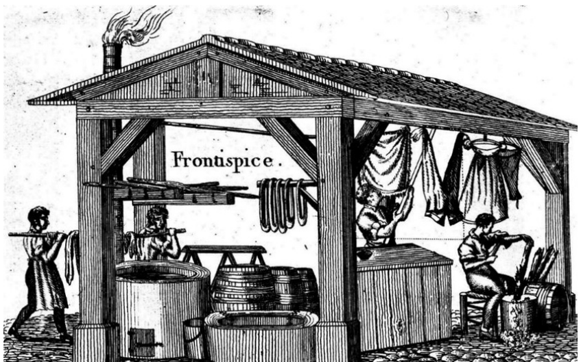
Fig. 31 Officine de teinturier au milieu du XIXe s. On y retrouve de grands tonneaux servant de cuves ainsi qu'une chaudière, le tout abrité sous un hangar. © http://www.google.fr/url?source=imglanding&ct=img&q=http://www.odile-halbert.com/Images/tteint.jpg&sa=X&ei=yi1KVZX0JsKAU-fEgcAK&ved=0CAkQ8wcc&usg=AFqjCNHd7WmiBlkPO2WmUOI-etWCj3LaiQ
