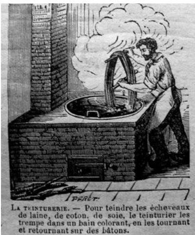
Fig. 32 Teinturier au travail devant sa chaudière fin XIXe s. Noter la configuration de la chaudière qui bien qu'étant plus petite, se rapproche sans doute assez de celle retrouvée sur le site © http://www.vieuxmetiers.org/gravure/imajpg/teinturier.jpg
