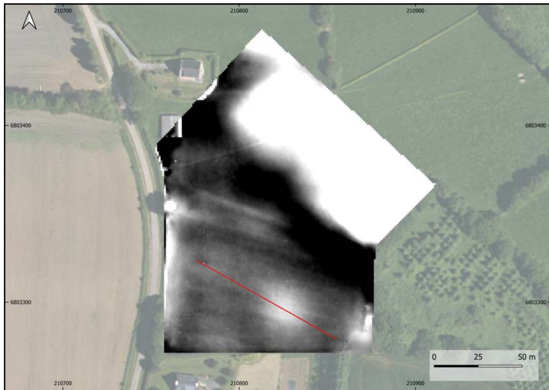
Simple Local Relief Model (R20) issu du MNT à 1m avec localisation du profil
