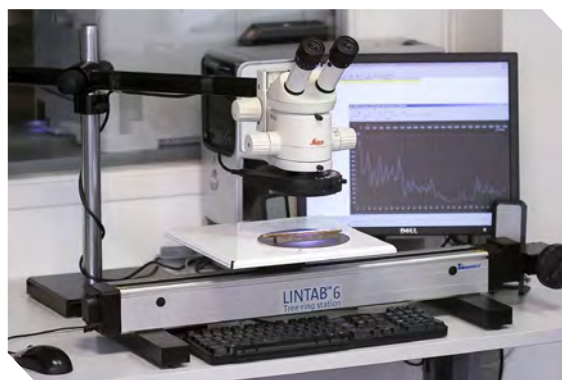
Appareils optique et informatique utilisés pour la mesure des cernes
