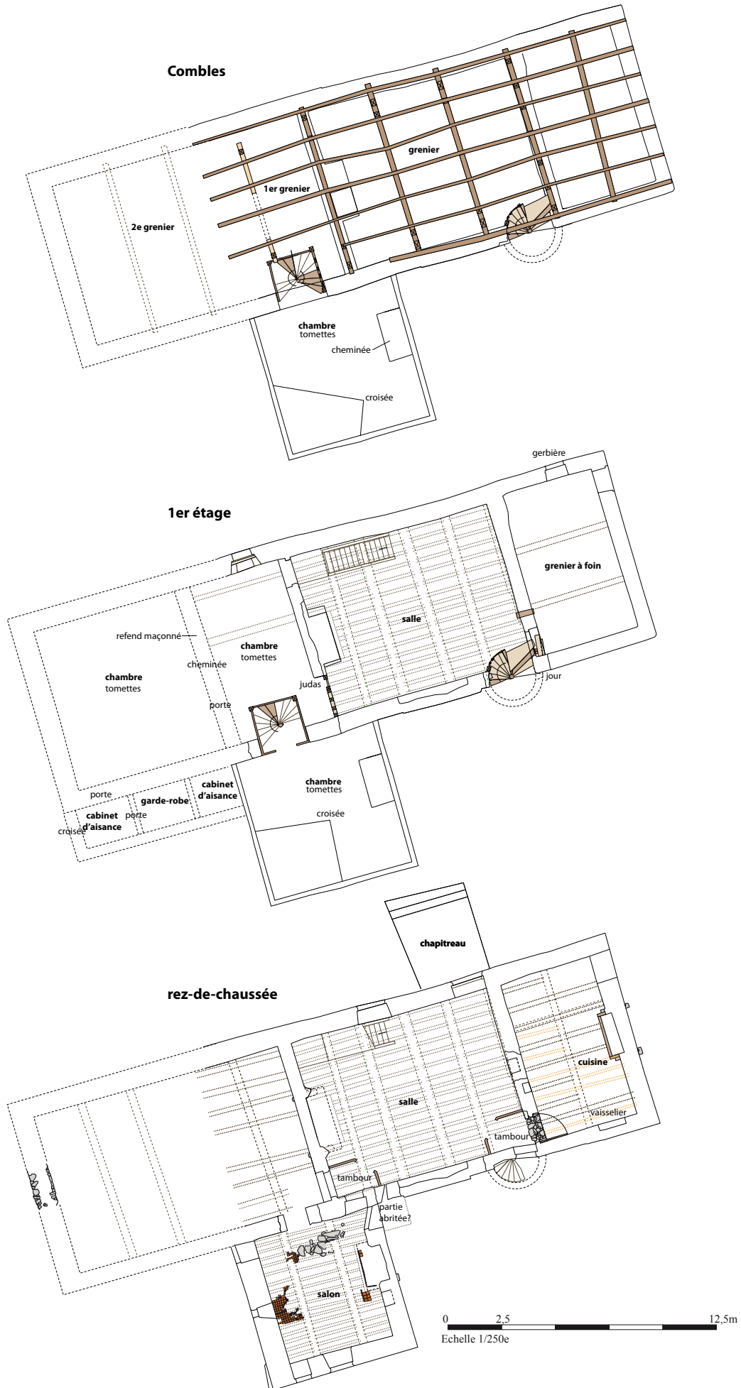
Fig.128 Hypothèse de restitution du quatrième état : la réduction orientale © E. Esnault, Inrap
