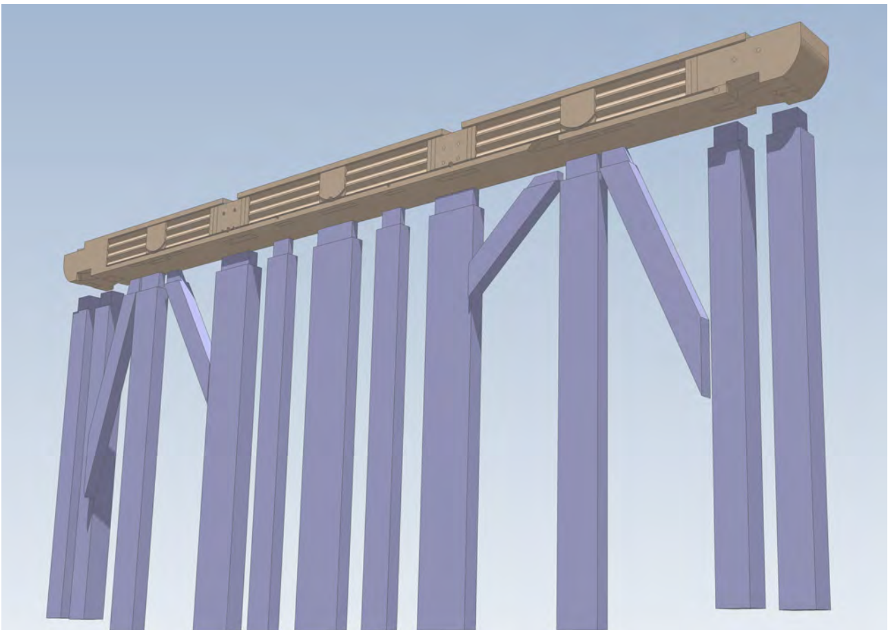
Fig.120 Proposition de restitution de la sablière © E. Esnault, Inrap
