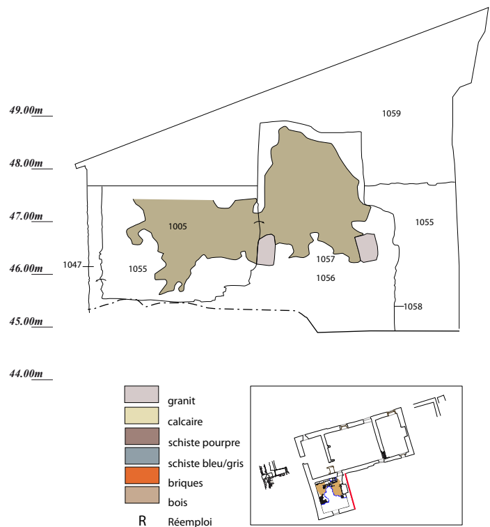
Fig.21 La façade est de l'aile en retour © Photogrammètrie P. Leblanc, DAO A. Desfonds, E. Esnault, Inrap
