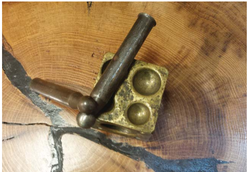
Fig. 2-221 Guipavas (29) - ZAC de Lavallot Nord, vue zénithale d'un jeu de pièces d'emboutissage composé d'un dé matriciel et d'embouts aux extrémités globulaires © F. Jodry, Inrap.
