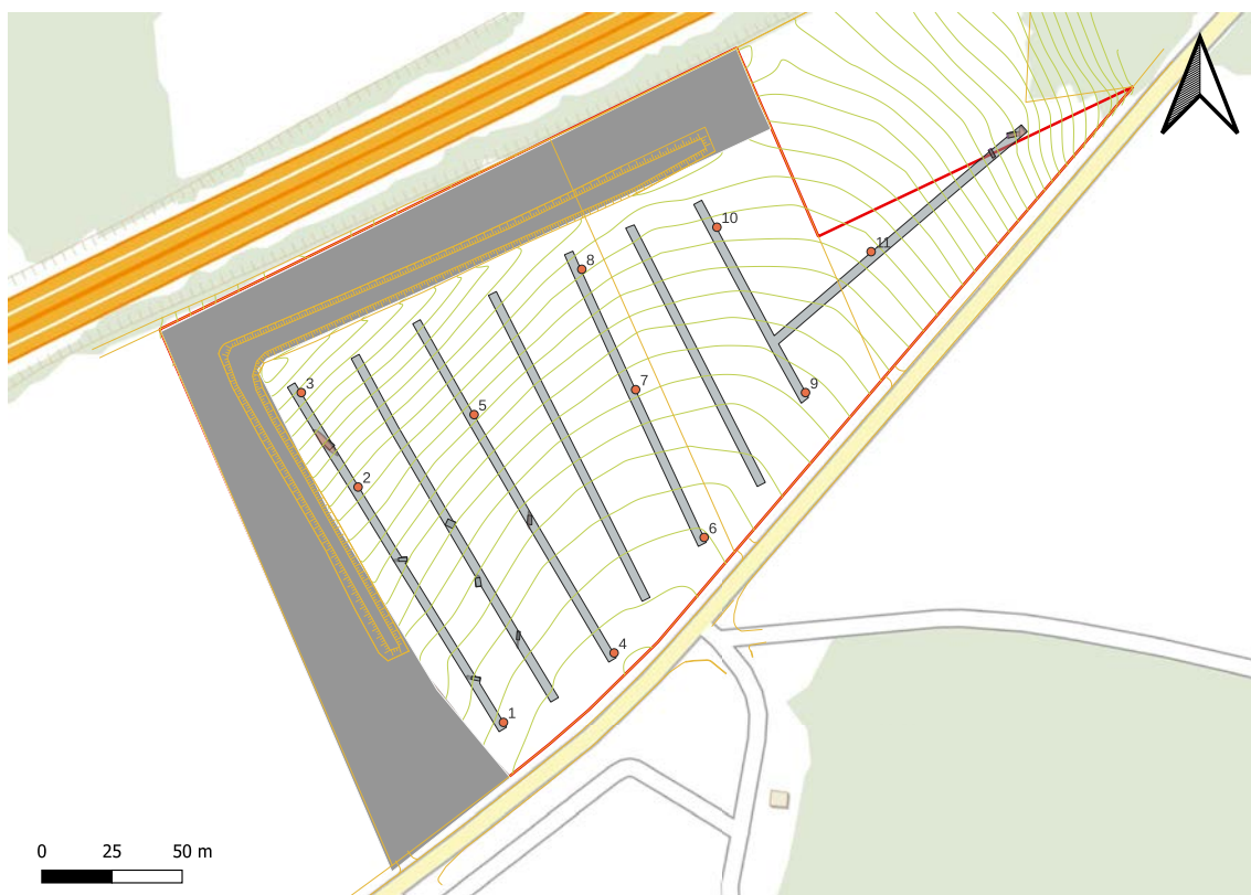
fig.10. Les Logs, dans l'ordre de 1 à 11 placés dans les tranchées
