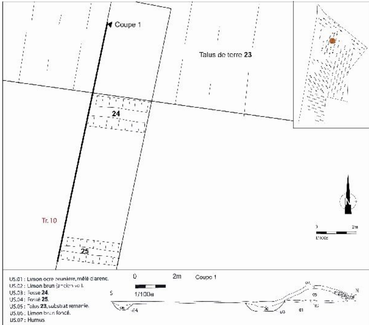
Figure n°17. : Coupe stratigraphique du talus 23 et des fossés 24 et 25, relevée au niveau de la tranchée n°10.
