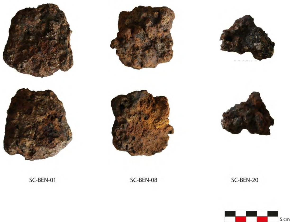
Figure 111a : exemples de culots de forge de type SGD (à gauche), SFR (au centre) et SAS (à droite)
