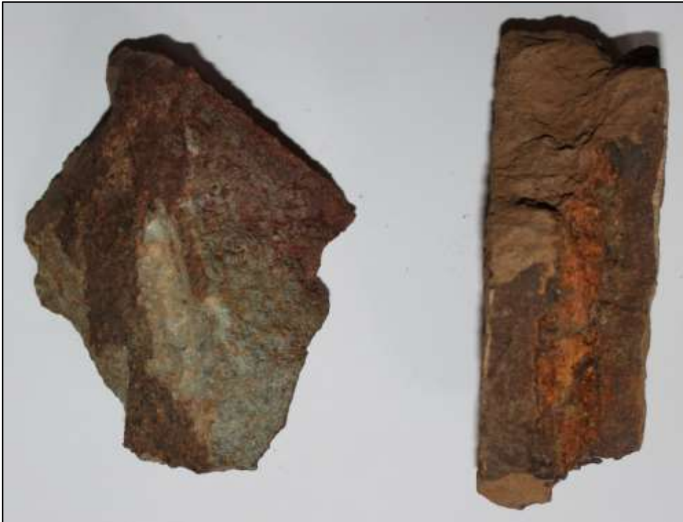
Doc. 9. À gauche : échantillon de métadolérite présentant des altérations de teintes allant du vert au rouge foncé en fonction des infiltrations argileuses ; à droite : échantillon de quartz présentant un cœur ferreux.
