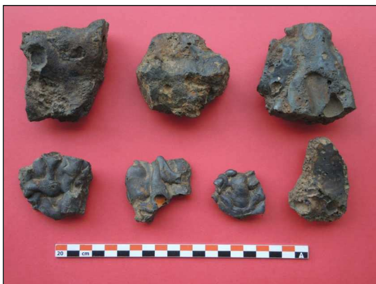
Scories de type écoulé à cordons denses étroits, voire larges et aussi fondus entre eux (face supérieure)
