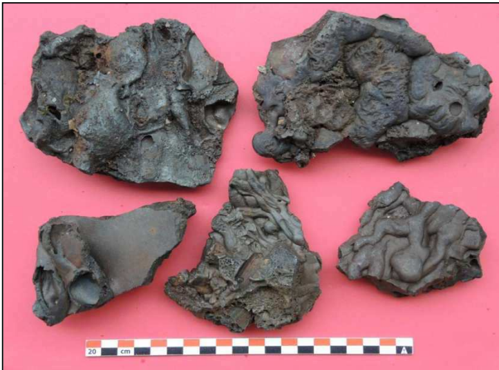
Scories de type écoulé à succession de cordons denses, à cordons larges et aplatis et à cordons fondus entre eux (face supérieure)
