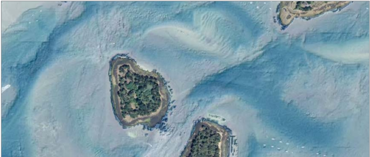
Figure 42 : Exemple d'estimation bathymétrique à partir d'imagerie hyperspectrale (Golfe du Morbihan)
