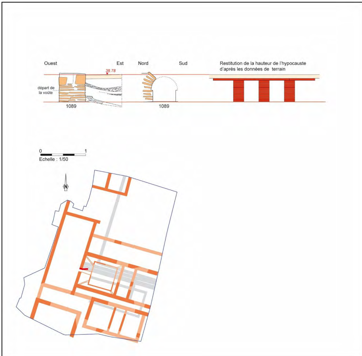
Fig.1-128 Restitution du profil de l'hypocauste et de la voûte du praefurnium © Arnaud Desfonds – Dominique Pouille Inrap
