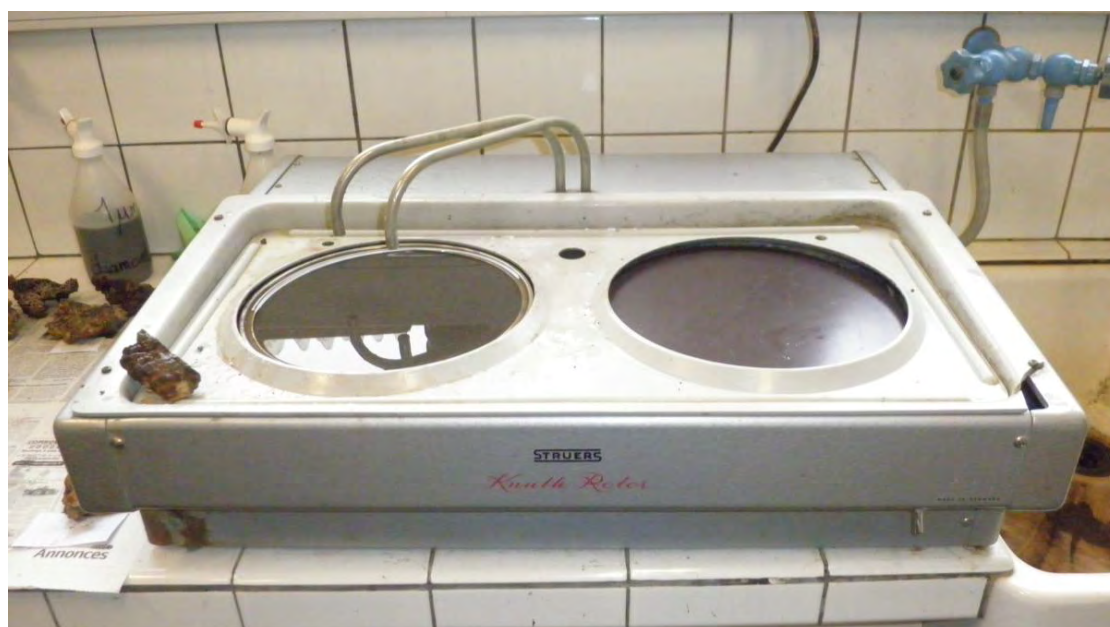
Fig. 11. Polisseuse rotative de marque Struers du laboratoire CReAAH (Cliché M. Lavoué).
