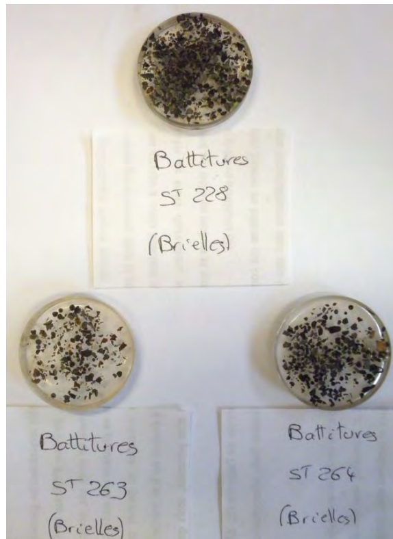
Fig. 15. Battitures retrouvées dans les trois fosses à scories du site de Brielles, incluses dans des plots en argile (Cliché M. Lavoué).
