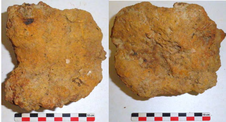
Fig. 46. Aspect macroscopique de deux scories ferreuses rouillées (A gauche, Ech. 436-32 ; à droite, Ech 436-33) (Clichés M. Lavoué).
