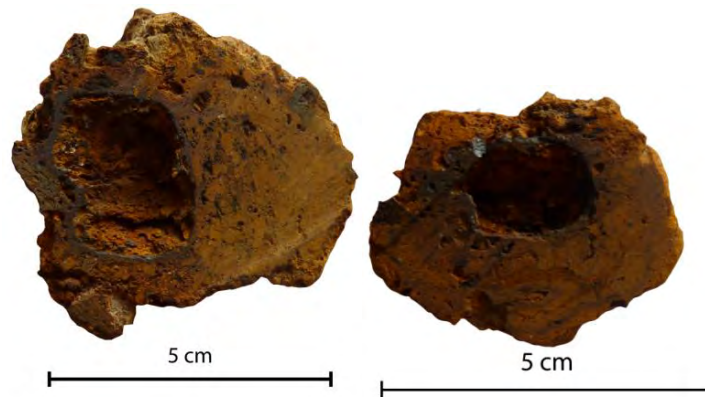
Fig. 29 Sections de scories ferreuses rouillées révélant des négatifs de barreaux de fer (Clichés M. Lavoué)
