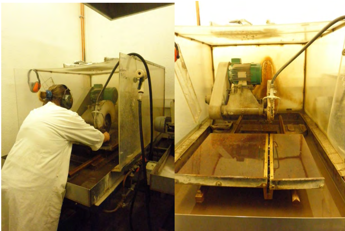
Fig. 10. Sciage des scories (à gauche), avec la scie circulaire diamantée de Géosciences, campus de Rennes 1 (à droite) (Clichés M. Lavoué).
