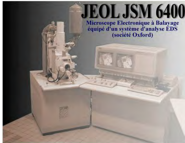
Fig. 13. Microscope Electronique à Balayage utilisé pour l'analyse chimique des déchets métallurgiques (Cliché CMEBA).
