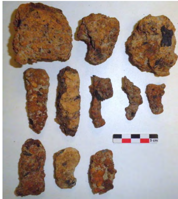
Fig. 27. Aspect macroscopique de scories ferreuses rouillées du site de Brielles (Cliché M. Lavoué).
