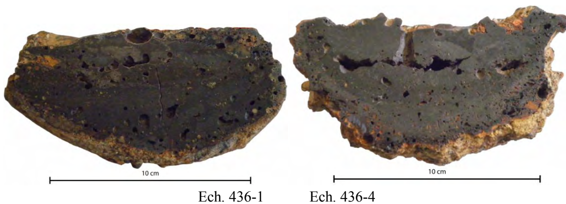
Fig. 43. Deux coupes de scories en culot du site de Gennes présentant une stratification (Clichés M. Lavoué).
