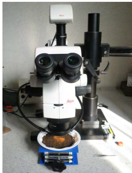
Fig. 14. Loupe binoculaire de marque Leica utilisée pour le tri des battitures (Cliché M. Lavoué).
