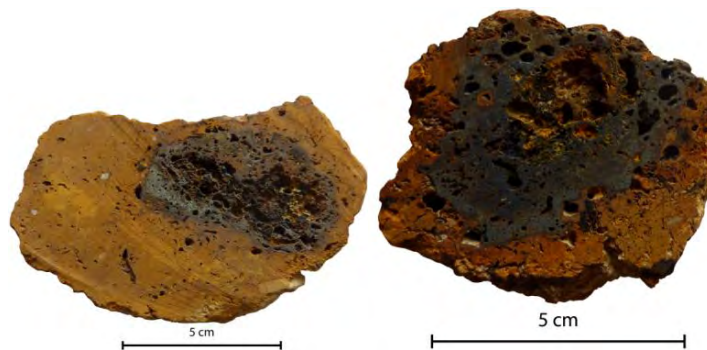
Fig. 30 Sections de scories ferreuses rouillées révélant des formes de métal fondu (Clichés M. Lavoué)
