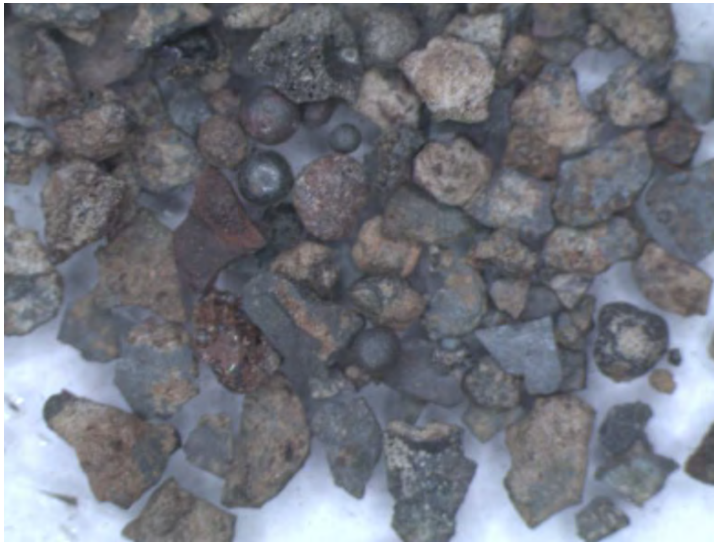
Fig. 37. Aspect macroscopique des battitures retrouvées dans le sédiment de la fosse 264 (Cliché M .Lavoué).
