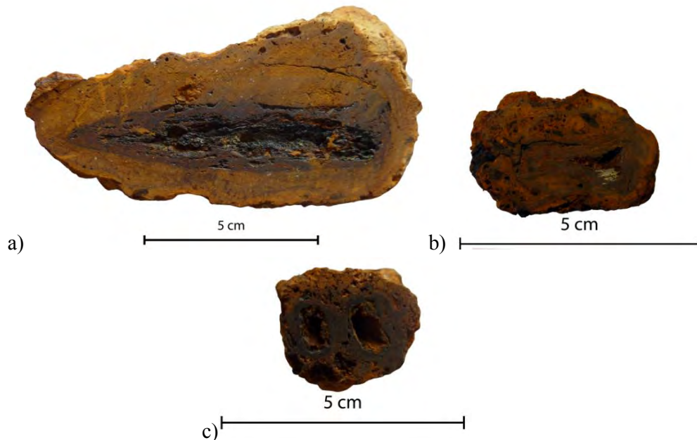
Fig. 28. Sections de scories ferreuses rouillées révélant des fragments de fer très altérés. a) fragment de pointe ? b) et c) fragments de barreau ? (Clichés M. Lavoué)
