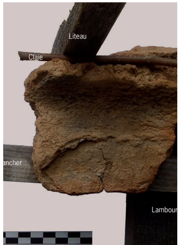
Fig. 7 Interprétation du lot 1 d'après les empreintes relevées sur le fragment. Vue oblique de la partie supérieure.
