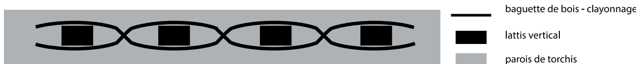
Fig. 9 Essai de restitution d'une paroi en pan de bois – vue en coupe longitudinale
